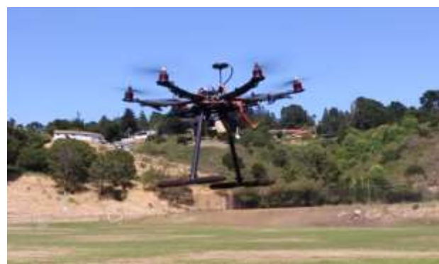
Figura 8 Prueba de dispersión de semilla de alfalfa
