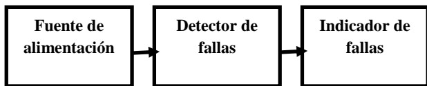
Figura 2 Etapas de operación del dispositivo detector de fallas eléctricas en convertidores de ozono
