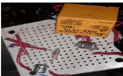
Figura 3a Vista frontal del circuito electrónico detector de fallas eléctricas de los convertidores de ozono.
