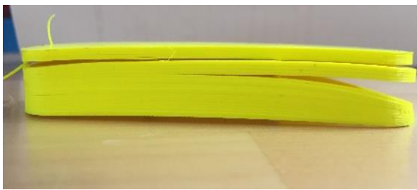
Figura 1 Pieza defectuosa del extremo derecho
