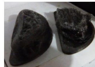
Figura 8 Almohadillas para mouse defectuosas de TPU
