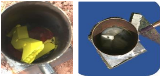
Figura 5 Pruebas de fundición para ABS y PLA
