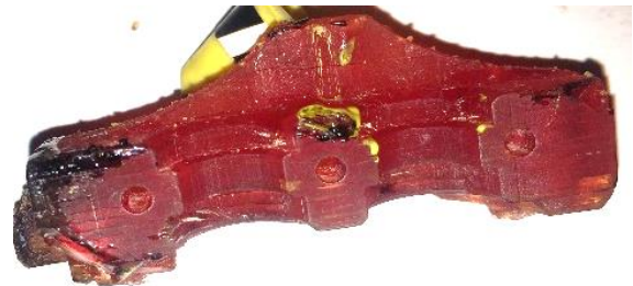
Figura 13 Pieza de resina SLA intacta después de pruebas de fundición
