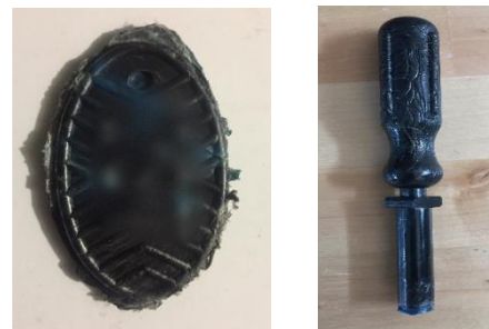
Figura 17 Piezas con buena cohesión, sin grietas ni burbujas de aire
