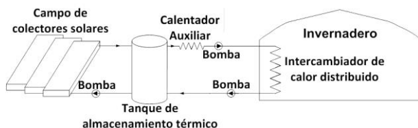
Figura 3 Esquema del sistema de calefacción solar asistido por gas propuesto
