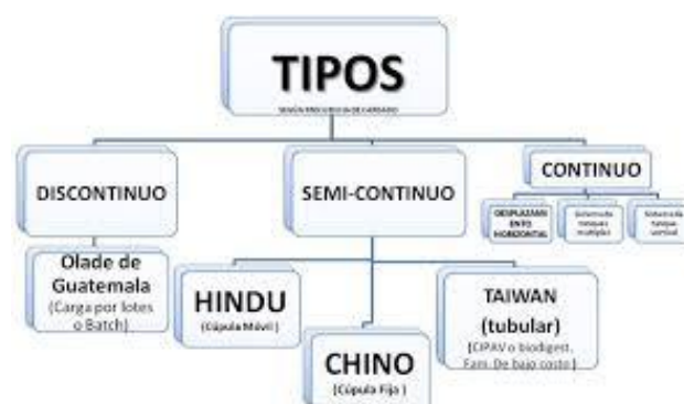
Figura 1 Tipos de biodigestores
