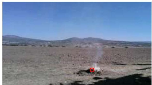
Figura 9 Identificación de fuego realizada por el algoritmo dos. Donde el recuadro rojo enmarca el área detectada
