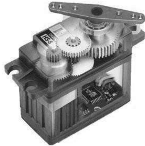
Figura 3 (izq) Vista del engranaje que conforma a un servomotor
