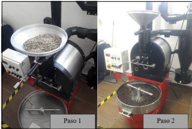
Figura 7 Proceso de tostado de café
