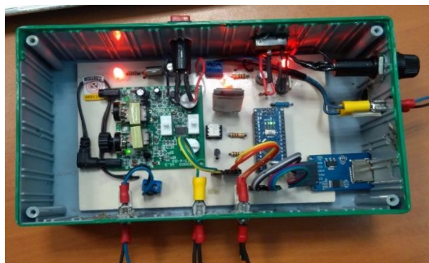
Figura 3 Dispositivo electrónico auxiliar terapéutico para el tratamiento del dolor provocado por trastornos músculo-esqueléticos
