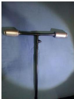
Figura 5 Ejemplo de antena dipolo elaborada con material reciclable
