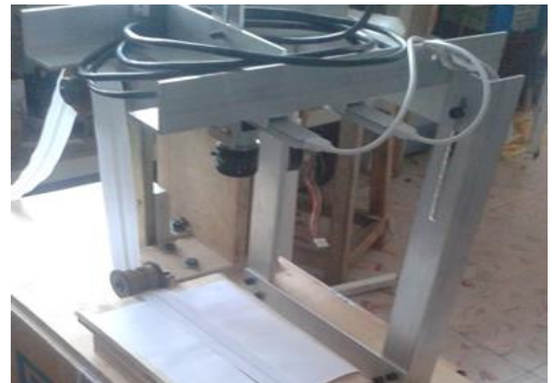
Figura 6 Estructura para las lámparas LED y cámara de Visión. Fuente: Elaboración propia
