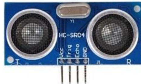
Figura 5 Sensor ultrasónico (HC-SR04).
