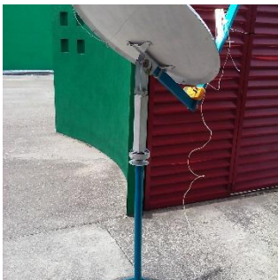
Figura 4 Concentrador de plato parabólico.
