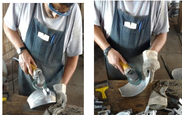
Figura 3 Fases finales del proceso de manufactura de un espejo colector de luz solar.
