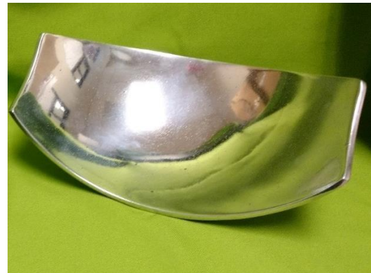
Figura 5 Colector solar con pulido hasta llegar a la apariencia de espejo reflector.
