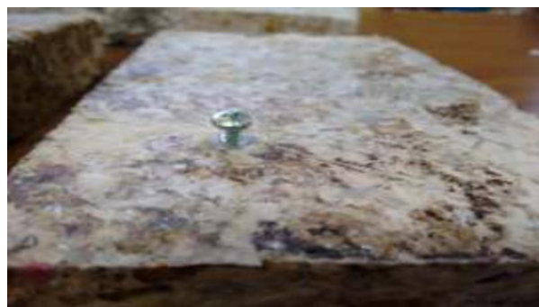
Figura 4 Bloque alojando un taquete y tornillo Fuente: Elaboración propia
