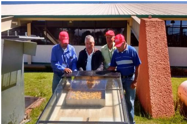
Figura 11 Secado de durazno en el deshidratador solar Fuente: CAIP
