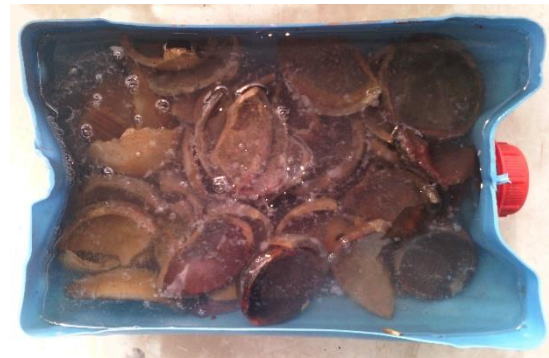
Figura 9 Restos de crisoles en la solución de sulfúrico.
