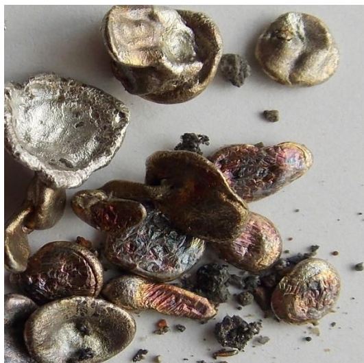
Figura 11 Granalla obtenida como aleación varios metales como: Ag, Au, Cu, Al, St, Zn, He, etc.
