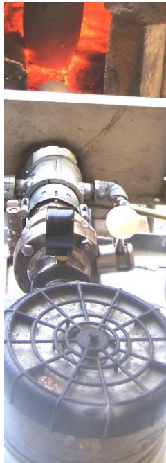
Figura 8 Polvo del precipitado adicionado con carbonato de sodio como fundente en el crisol dentro de la fragua de carbón vegetal de fundición. , utilizando un cañón alimentado con gas LP, para alcanzar la temperatura requerida de arriba de 1400^{\circ}\text{C} .
