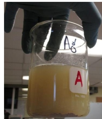
Figura 4 Sobrenadante conteniendo moléculas de plata.
