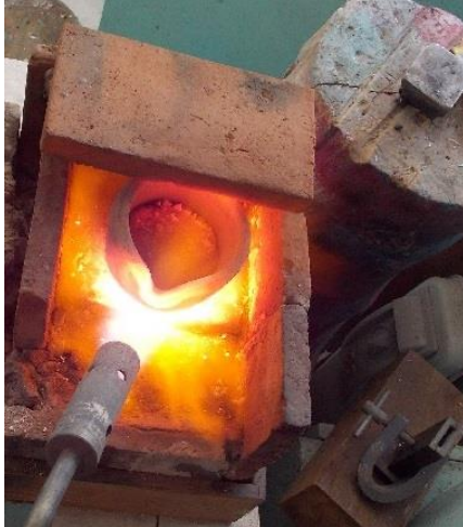
Figura 6 Polvo del precipitado adicionado con carbonato de sodio como fundente en el crisol de fundición. Temperatura aproximada requerida 1200°C.
