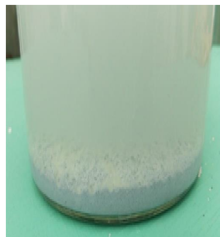
Figura 12 Cloruro de plata precipitado al fondo del recipiente.
