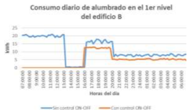
Gráfico 1 Comparación entre el consumo de luminarias sin estrategia de ahorro de energía (línea azul) y con estrategia de ahorro de energía (línea naranja)
