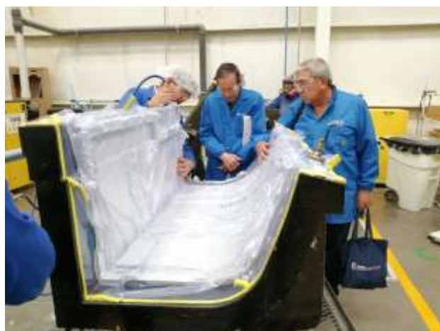
Figura 1 Molde para fabricación de asientos de avión
