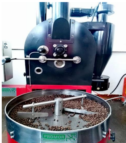
Figura 2 Enfriado de Grano de café tostado Fuente: Laboratorio de Ingeniería Industrial de la Universidad Veracruzana
