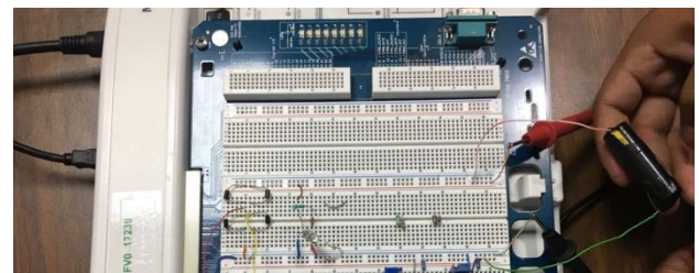
Figura 6 Plataforma de pruebas NI ELVIS II de National Instruments Fuente: Elaboración Propia
