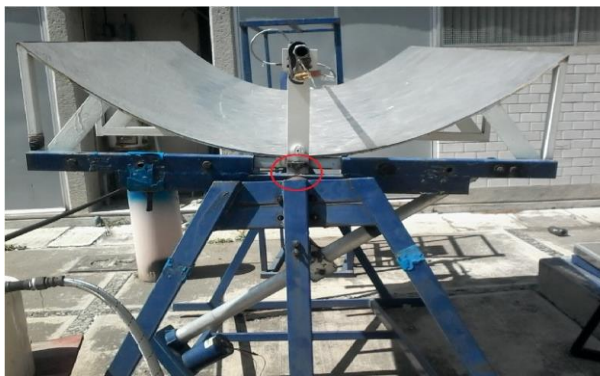
Figura 13 Eje de rotación del concentrador solar parabólico (círculo rojo) Fuente: Elaboración Propia
