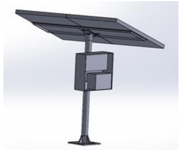
Figura 7 Fijación de gabinete con equipo de control y almacenamiento
