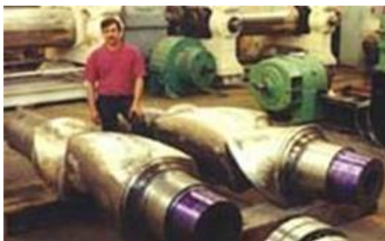
Figura 11 Rodillos remanufacturados antes de ser enviados al Canadá para su ensamble final en un banbury por dos técnico de NORAMEX. Área de ensamble Nave #1
