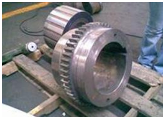
Figura 4 Relleno y reparación de camisas de acero con soldadura, donde se ensamblan los bujes de bronce. Nave #1
