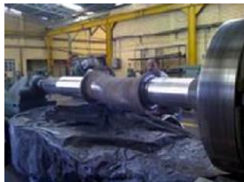
Figura 7 Rodillo Montado en torno de 7 metros de bancada con la operación de remaquinado de los extremos, Nave #3
