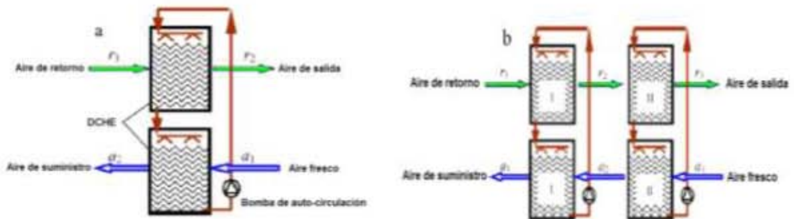
Figura 5.3 Intercambiador de calor con desecante líquido: (a) un estado y (b) doble estado (Li Z, 2005)
