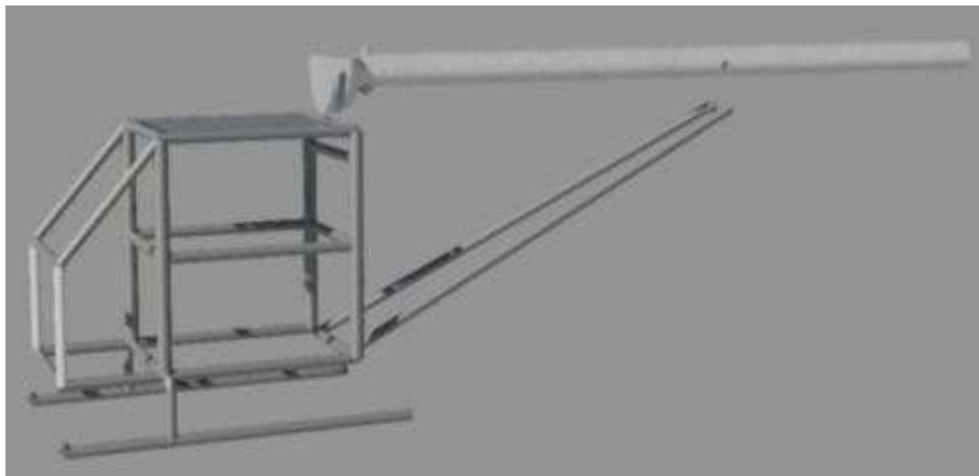
Figura 10 Ensamble de cola y cabina
