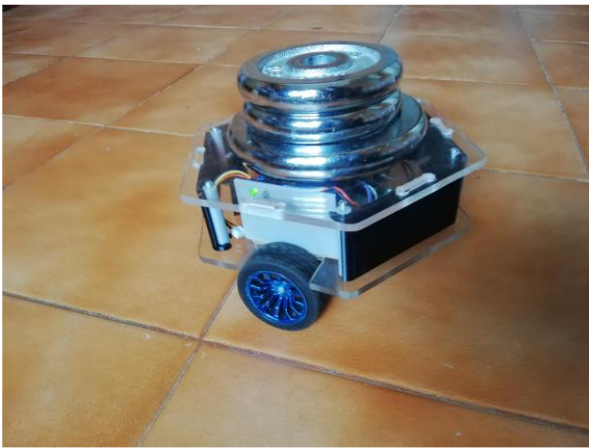
(a) Peso soportado por el vehículo 5Kg
