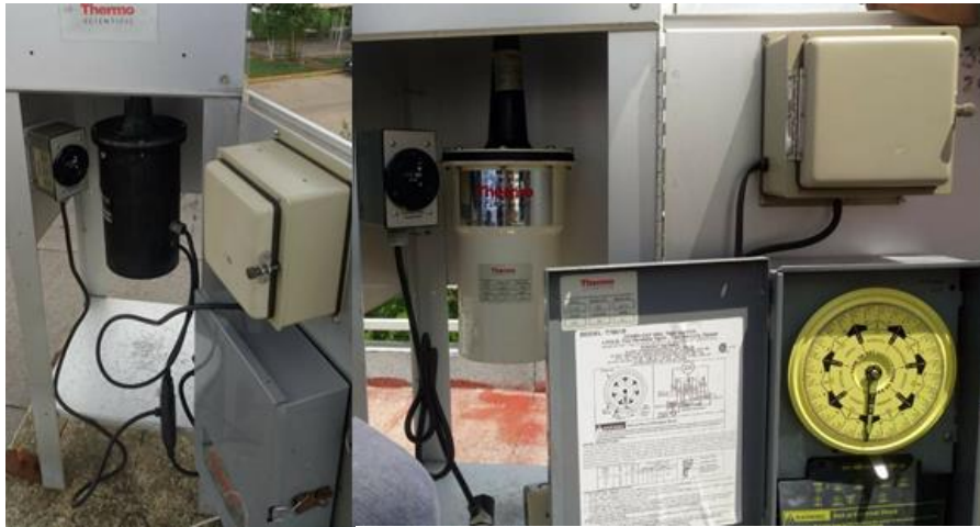
Figura 7.5 Sección baja del equipo PM 10 (se muestra el reloj temporizador, el graficador de tiempo y flujo, el motor de succión)
