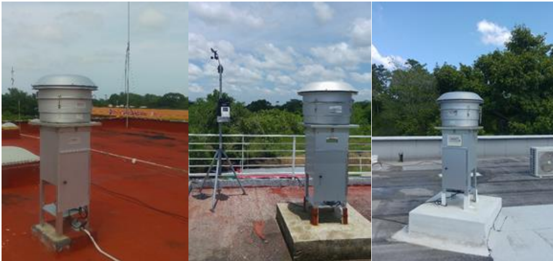
Figura 7.3 Equipos Muestreadores de Alto Volúmenes (High Volume Sampler, HVS) utilizado en los monitoreos de la Red Multi-Institucional de Monitoreo de Partículas PM_{10} en el Estado de Tabasco
