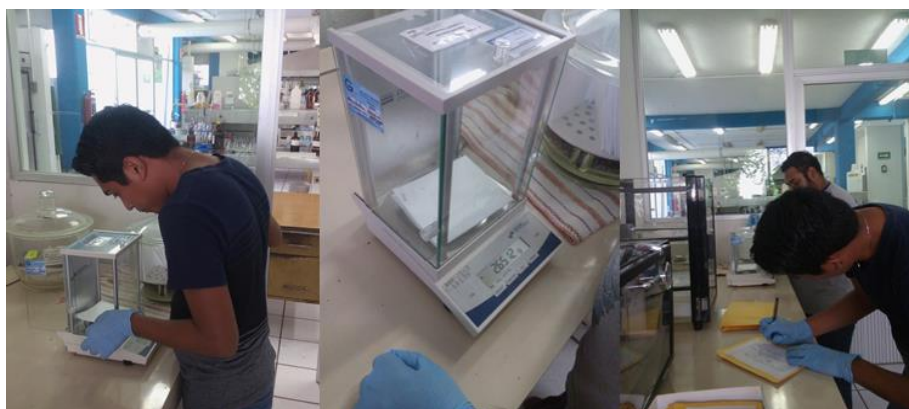
Figura 7.9 Pesado del filtro en una balanza analítica para obtener un peso inicial previo al muestreo
