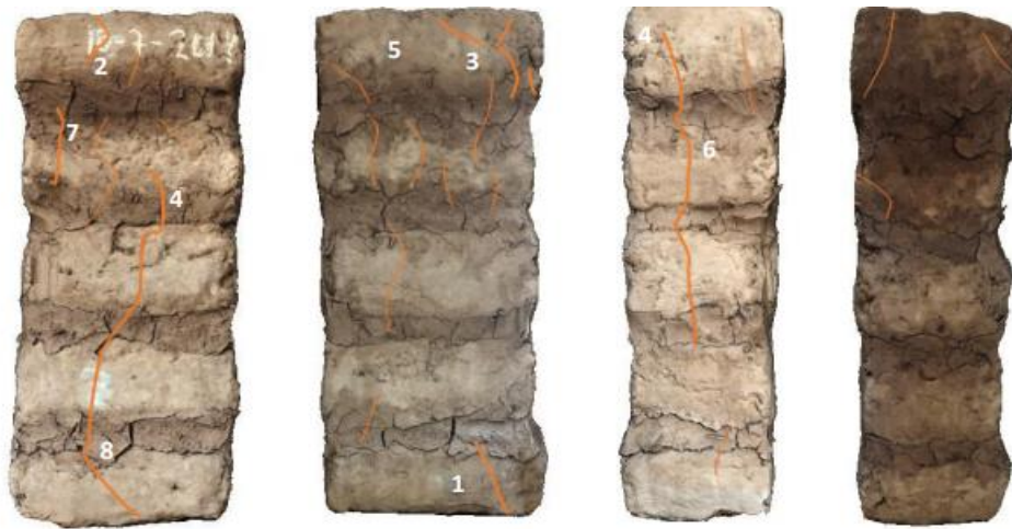
Figura 4 Evolución de grietas en el prisma de adobe: a) vista frontal, b) vista posterior, c) y d) caras laterales. Grietas 1, 2, 3 y 5 se originan en la zona de contacto con el equipo Grieta 4 en la zona central empieza en la junta de mortero y se propaga a todo el muro. La grieta 6 se genera en una cara lateral del prisma y se propaga verticalmente. Grieta 7 se generando en la junta de mortero. El progreso de la grieta 4, se produce la grieta 8 que presenta una longitud considerable. No se logró registrar la aparición y evolución del resto de grietas debido a que cuando se alcanzó la carga máxima estas se propagaron súbitamente en todo el espécimen
