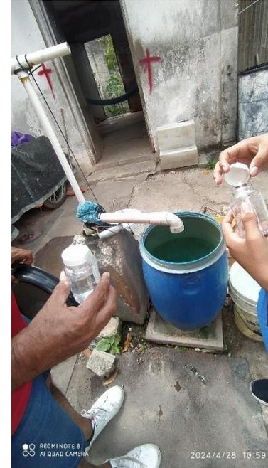
*Toma de muestra de agua , de pozo construido de forma artesanal. Fuente M: Basto*
