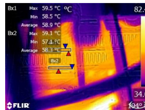
a) Figura 3. Mapeo puntual de la zona de estudio del radiador de motocicleta en funcionamiento a) termografía aislada en ductos de aceite, b) fotografía
