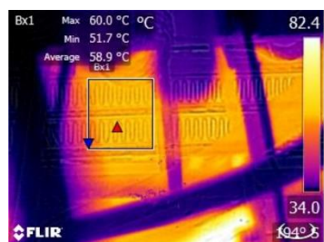
a) Figura 2. Radiador con la motocicleta en funcionamiento. a) termografía, b) fotografía, c) perfil termográfico
