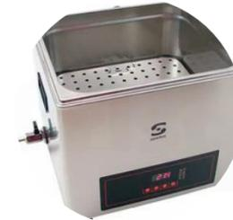
Baño para controlar la temperatura en todos los experimentos.
