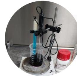
Agitador magnético con placa de calentamiento.
