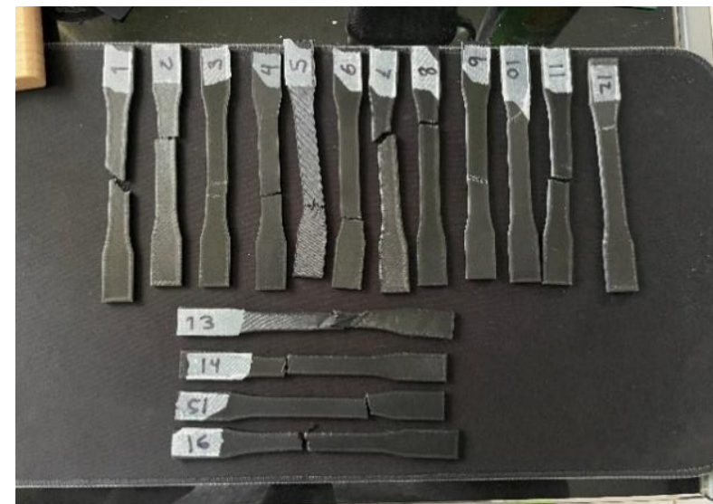
Figura 11: Modelos de la ASTM D638 impresos en FFF con PETG-CF según el DOE de la matriz ortogonal L 16
