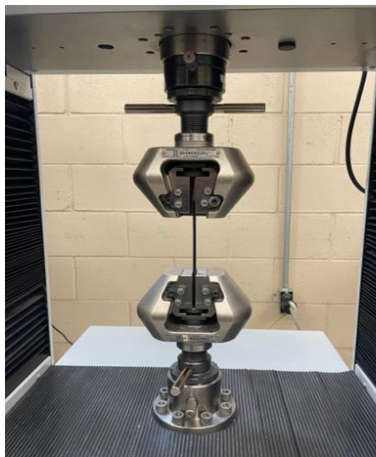
Figura 10: Máquina de tensión realizando el trabajo de tracción en probeta.
