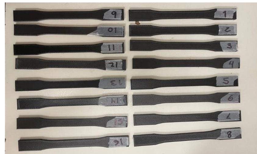
Figura 9: Modelos de la ASTM D638 impresos en FFF con PETG-CF según el DOE de la matriz ortogonal L 16
