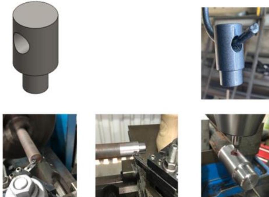
Figura 8. Pieza 3) Cilindro guía-Torneado, Taladrado
