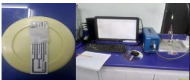
Figura 1 Celda de Pt impresa y Potenciostato/Galvanostato Fuente: Elaboración Propia
