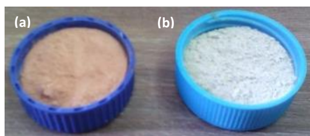
Figura 3 (a) Jal de Pinos Altos y (b) Jal de Pinos Altos tratado con Triisopropanolamina
