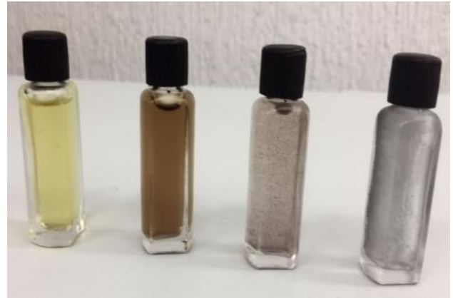
Figura 2 Nanopartículas de plata precipitadas en color violeta y gris
