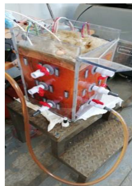
Figura 2 Pruebas realizadas con la microburbuja en el equipo de electrocoagulación
