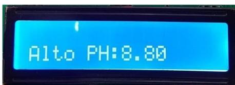
**Figura 8** Pantallas LCD permitiendo la visualización de los valores obtenidos en los sensores
