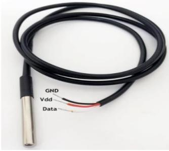
Figura 3 Sensor de Temperatura
