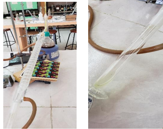
Figura 7 Recuperación de Metanol por destilación Fuente: Elaboración Propia
