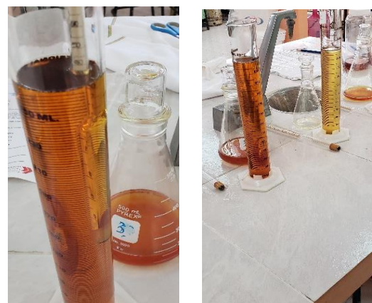
Figura 4 Determinación de la densidad Fuente: Elaboración Propia
