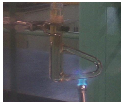
Figura 8 Determinación del punto de ebullición de la glicerina Fuente: Elaboración Propia
