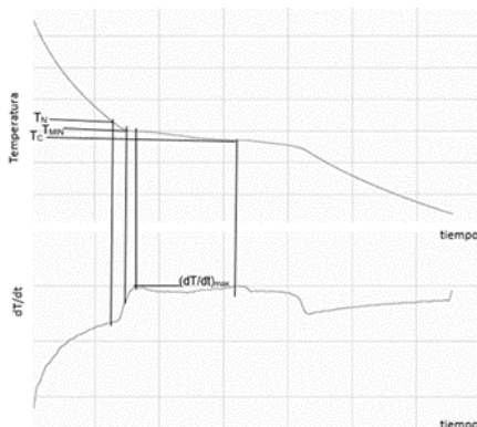
Figura 2 Determinación de temperaturas características. Los resultados obtenidos a partir de este análisis son resumidos en la tabla 1
