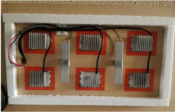
**Figura 4** Montaje de resistencias calefactoras
