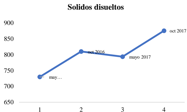
Gráfico 1 Resultados de los sólidos disueltos totales, nos indica que, en el mes de octubre 2017, tiene la una alta carga de contaminantes, ocasionados por filtración al manto por la fragilidad de sus suelos que son escasos, cavernosos por esta zona Fuente: Elaboración propia
