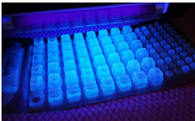
Figura 5 Resultados de la muestra de agua mayo 2016 y octubre 2016-2017, Enterococci, al pasar la lampara de uv en un cuarto oscuro hay presencia de fluorescencia Fuente: Elaboración propia
