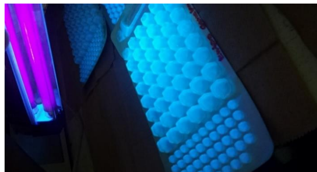
Figura 6 Resultados de la muestra de agua mayo 2017 y octubre 2017, Enterococci, al pasar la lampara de uv en un cuarto oscuro hay presencia de fluorescencia Fuente: Elaboración propia
