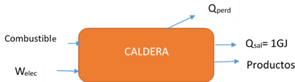
Figura 2 Unidad funcional analizada
