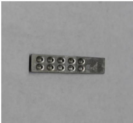
Figura 1 Crio-placa de aluminio utilizado para la crioconservación
