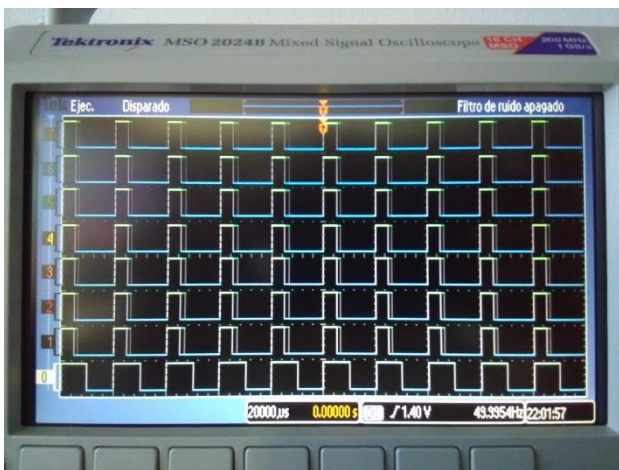
Figura 8 Señales PWM de prueba Fuente: Elaboración Propia
