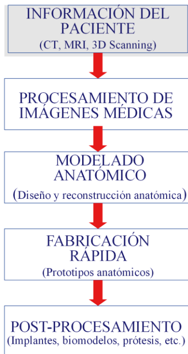
Figura 5 Método asistido por la ingeniería para el diseño y fabricación de prótesis
