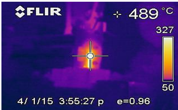
Figura 1 Espectro térmico durante el proceso de soldadura de la región donde se encuentra el perno. Fuente: Elaboración propia
