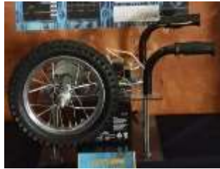
Figura 3 Prototipo, sensor de fuerza en el manillar
