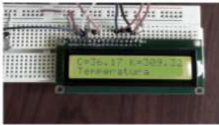
Figura 18 Datos de temperatura mostrados en LCD
