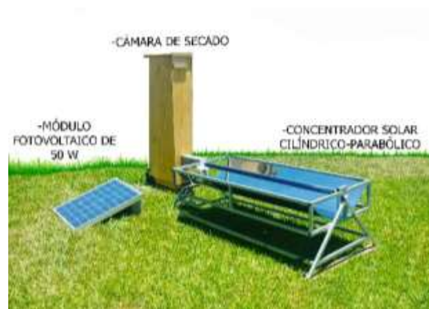
Figura 4 Sistema de deshidratación completo
