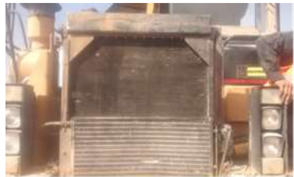
Figura 10 Este radiador (enfriador) de un camión articulado marca Caterpillar
