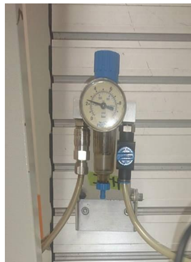
Figura 10 Calibración de sensor de presión mediante una fuente neumática (compresor) con valor conocido de presión mediante indicador marca FESTO
