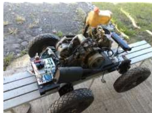
Figura 8 Fotografía del motor de combustión interna acoplado a la plataforma robótica móvil
