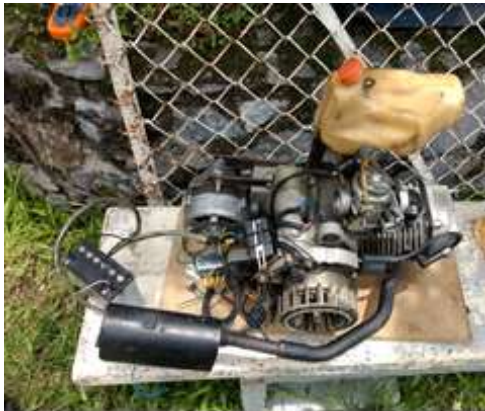
Figura 6 Motor de combustión interna utilizado para recargar las baterías
